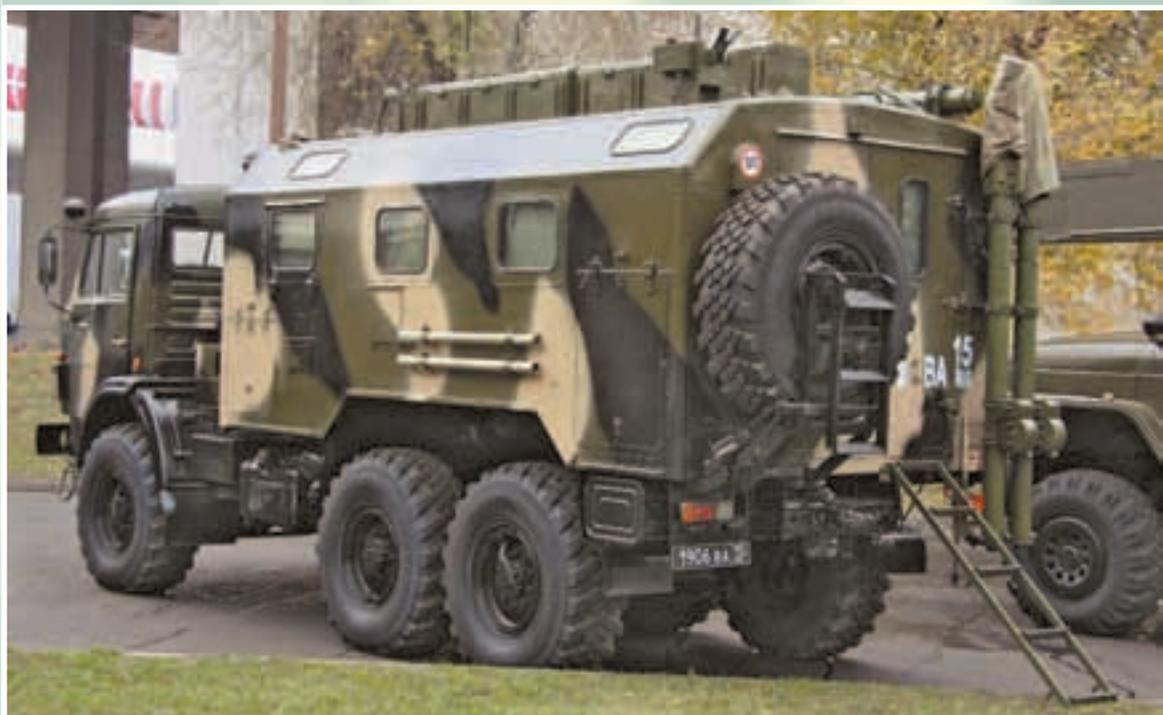
Комплексная аппаратная связи «Малолеток» на шасси КамАЗ-43114 – современный многоканальный подвижной узел связи, который к тому же может определять свои координаты по спутнику
