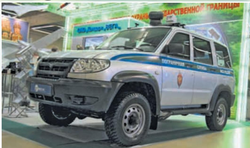
Система видеонаблюдения и видеосъёмки у Следопыта устанавливается на крыше. В комплект входят видекамера Sony и тепловизионная камера Thermal Eye
